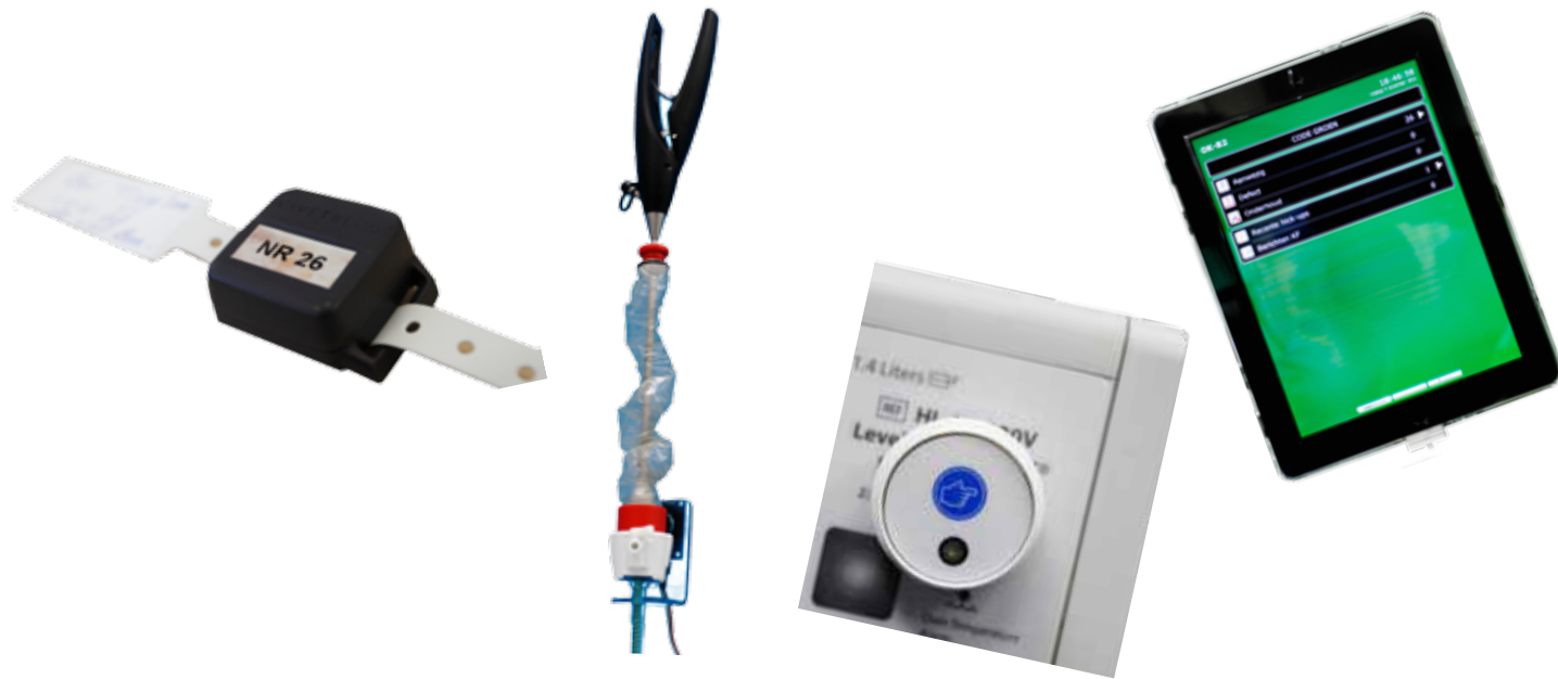
V.I.n.r. polsbandje met chip; doorvoer met kleurdetector; Rfid-chip apparatuur; iPad.
